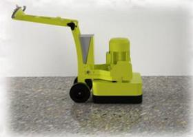
**Flexibler Schleifdruck 230-336kg**
